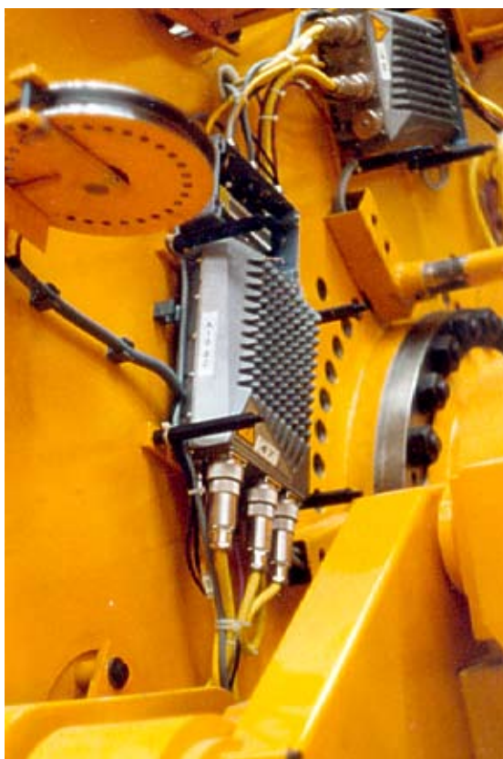
Blick auf ANDRAS Servosysteme, die mit bis zu 4g beschleunigt werden
