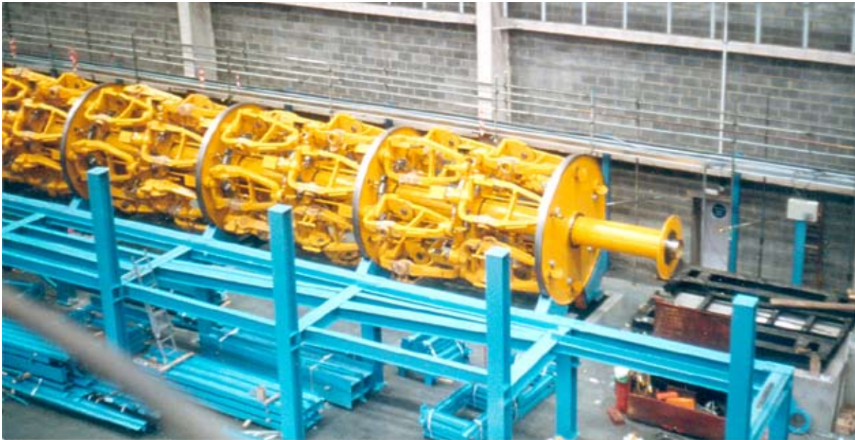
Drahtkorb Nr. 1 während der Anlagenaufbauphase
